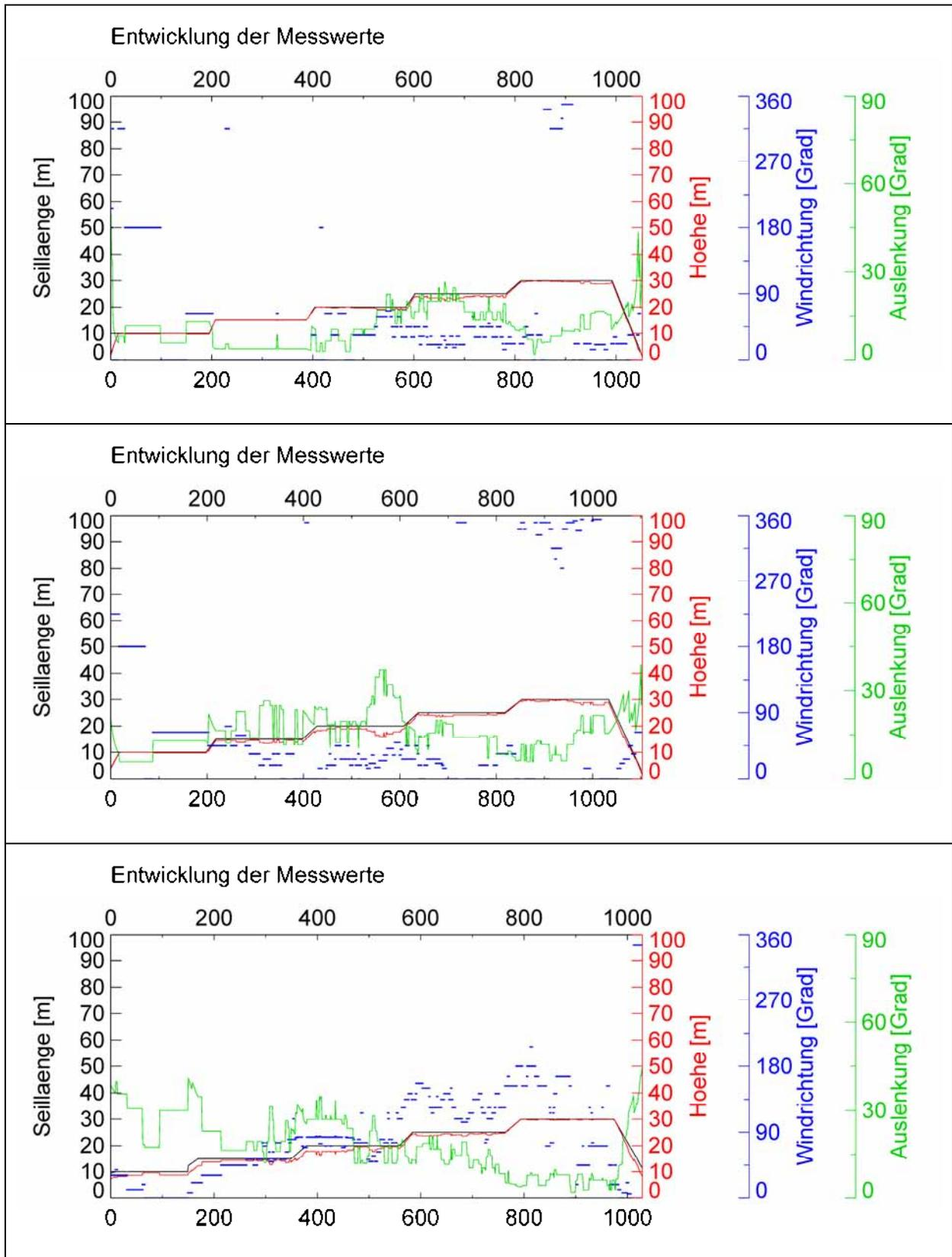
Abbildung 158: Liniendiagramme der Auslenkungsstärke des Heliumballons und der Windrichtung am Standort „Sigmaringen“ am 08.09.2008. Erläuterungen im Text.
