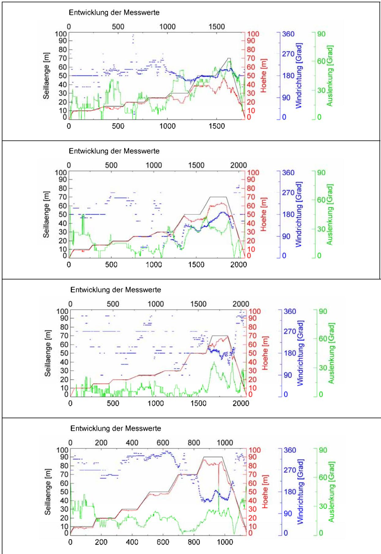
Abbildung 199: Auslenkungsstärke und -richtung des Heliumballons am Standort „Weiherstobel“ am 20.10.2008. Von oben nach unten: Erste, zweite, dritte und vierte Messung. Erläuterungen im Text.
