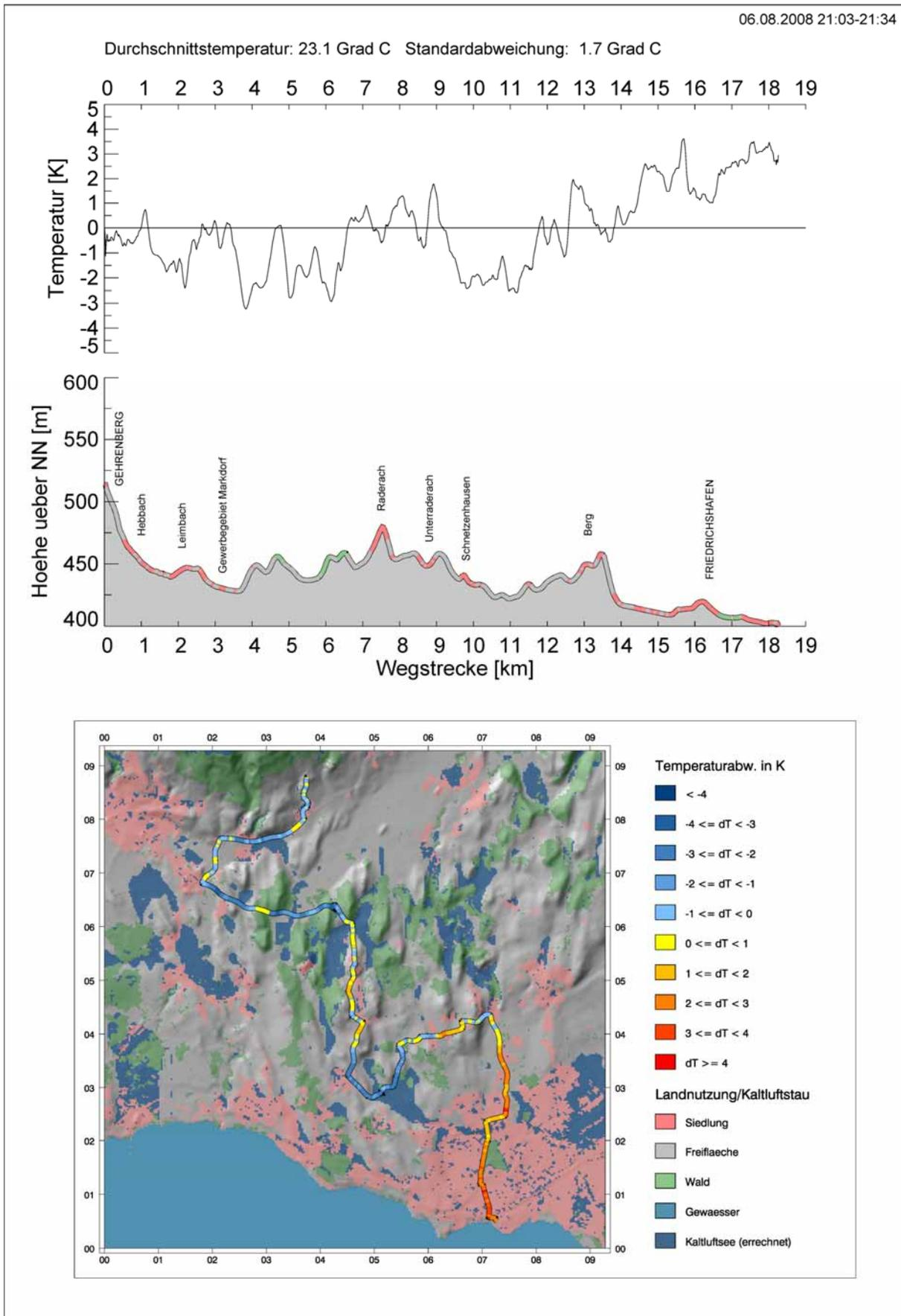
Abbildung 82: Ergebnisse einer Temperaturmessfahrt zwischen Gehrenberg und Friedrichshafen am 06.08.2008 zwischen 21:03 Uhr und 21:34 Uhr MESZ.
