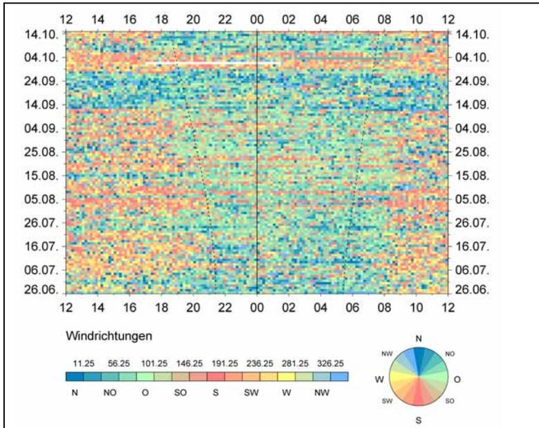
Abbildung 175: Isoplethendarstellung der Windrichtungen an der Station „Wolfeggerach“.
