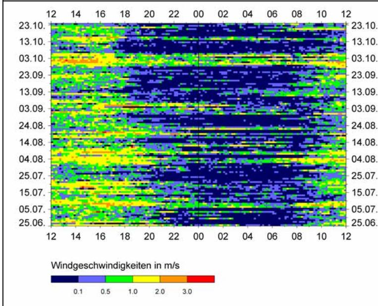
Abbildung 179: Isoplethendarstellung der Windgeschwindigkeiten an der Station „Scherzach“.
