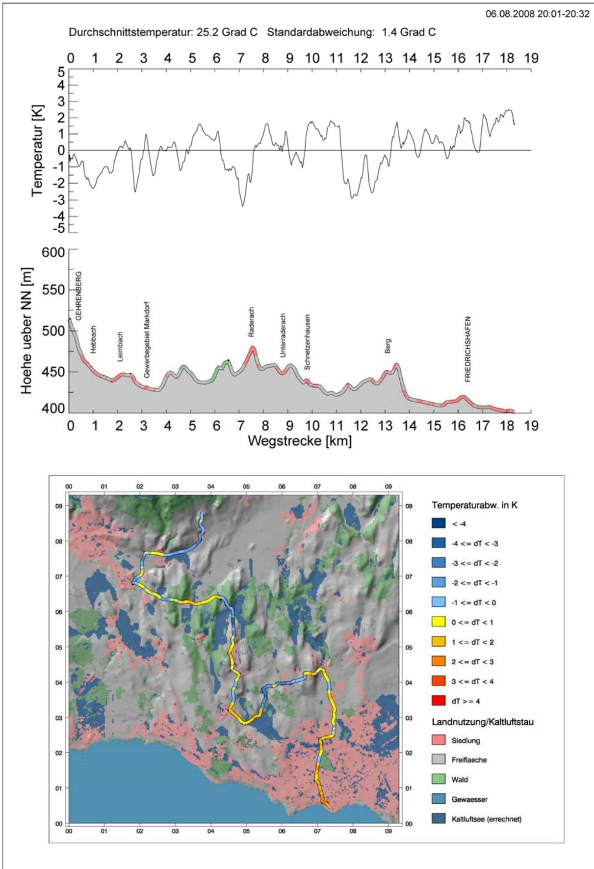
Abbildung 81: Ergebnisse einer Temperaturmessfahrt zwischen Gehrenberg und Friedrichshafen am 06.08.2008 zwischen 20:01 Uhr und 20:32 Uhr MESZ.
