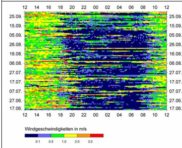
Abbildung 69: Isoplethendarstellung der Windgeschwindigkeit an der Station „Schnetzenhausen“.
