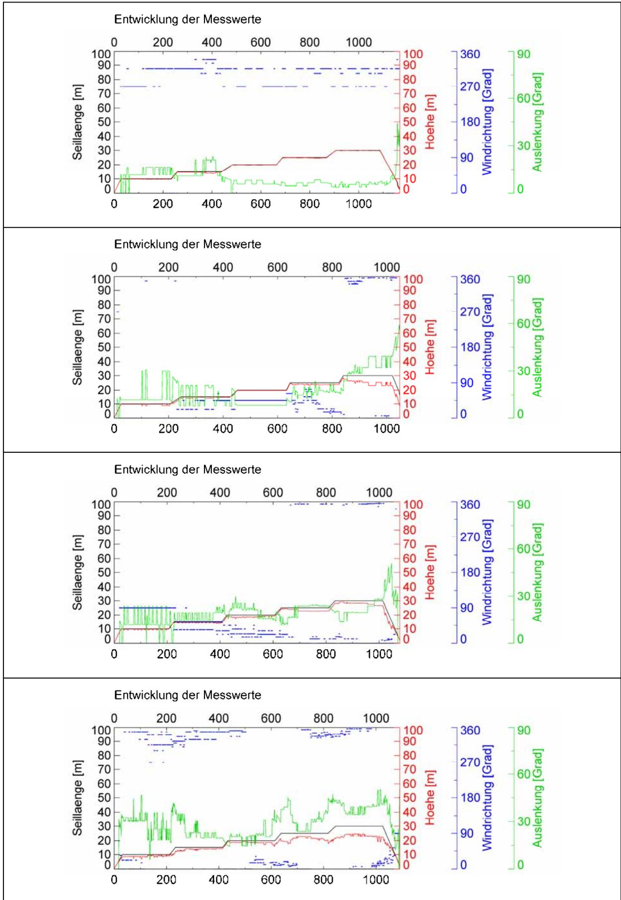
Abbildung 197: Liniendiagramme der Auslenkungsstärke des Heliumballons und der Windrichtung am Standort „Hähnlehof“ am 09.09.2008 (vgl. Kap. 3.3). Dritte Messung, vierte Messung. Erläuterungen im Text.
