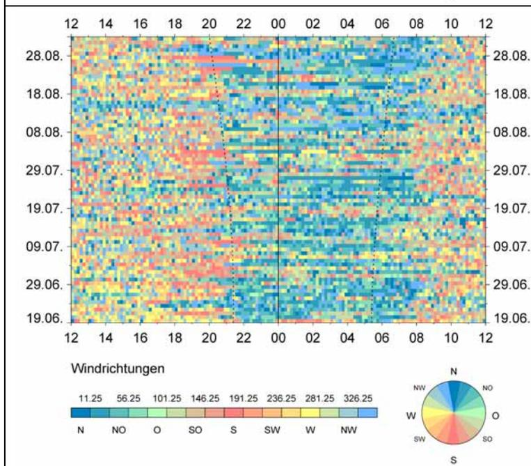
Abbildung 96: Isoplethendarstellung der Windrichtungen an der Station „Kochermühle“.
