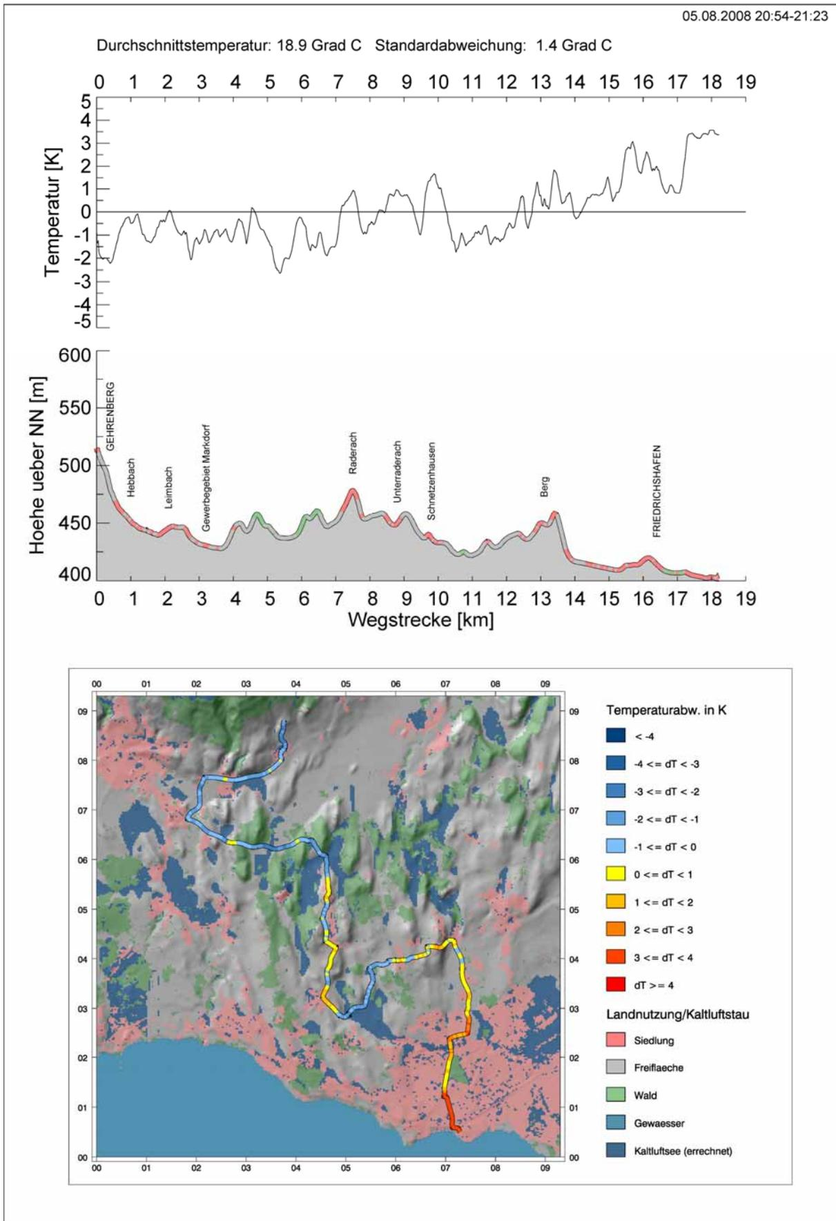
Abbildung 79: Ergebnisse einer Temperaturmessfahrt zwischen Gehrenberg und Friedrichshafen am 05.08.2008 zwischen 20:54 Uhr und 21:23 Uhr MESZ.
