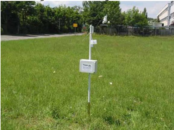
*Basisstation im Elektronik-Schutzgehäuse*
