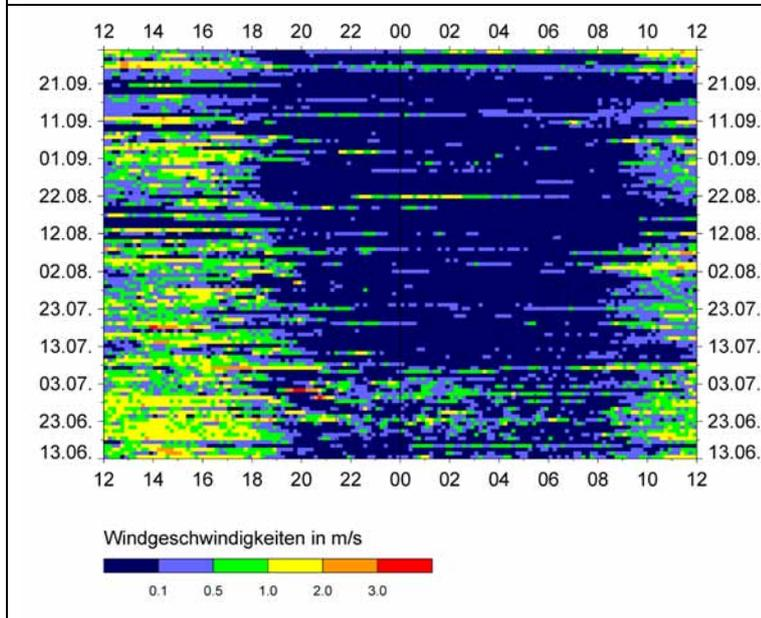
Abbildung 68: Isoplethendarstellung der Windgeschwindigkeit an der Station „Raderach“.
