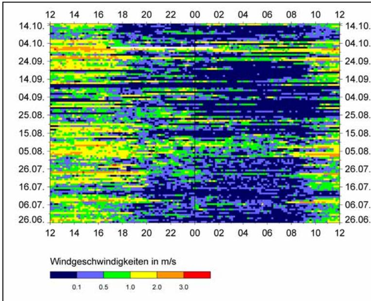
Abbildung 178: Isoplethendarstellung der Windgeschwindigkeiten an der Station „Wolfeggerach“.
