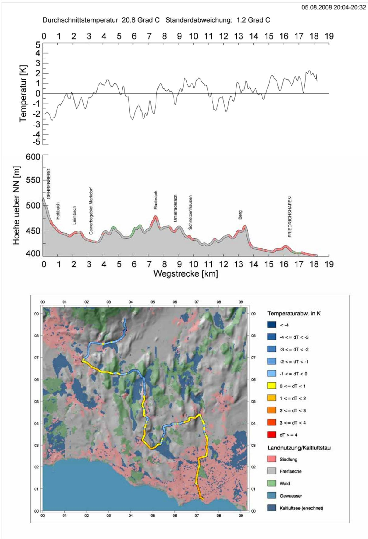
Abbildung 78: Ergebnisse einer Temperaturmessfahrt zwischen Gehrenberg und Friedrichshafen am 05.08.2008 zwischen 20:04 Uhr und 20:32 Uhr MESZ.
