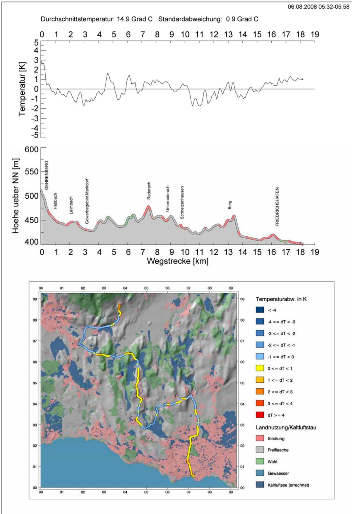
Abbildung 80: Ergebnisse einer Temperaturmessfahrt zwischen Gehrenberg und Friedrichshafen am 06.08.2008 zwischen 05:32 Uhr und 05:58 Uhr MESZ.
