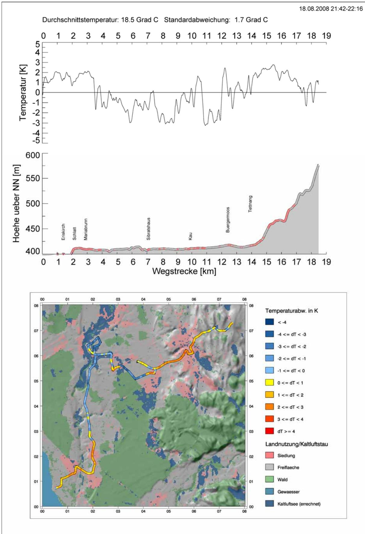
Abbildung 127: Ergebnisse einer Temperaturmessfahrt zwischen Tettnang, Lochbrücke und dem Bodenseeufer bei Ereskirch am 18.08.2008, 21:42 Uhr – 22.16 Uhr MESZ.
