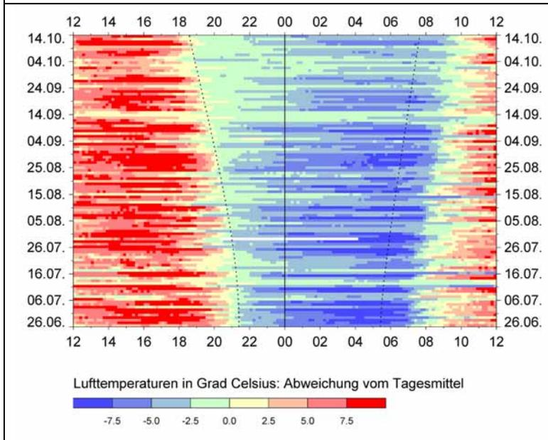
Abbildung 174: Isoplethendarstellung der Lufttemperaturen an der Station „Oberhofen“. Abweichung vom Tagesmittel.
