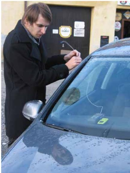
Abbildung 7: Anbringen von GPS-Gerät und Temperaturlogger am Fahrzeug vor der Durchführung einer Temperaturmessfahrt.
