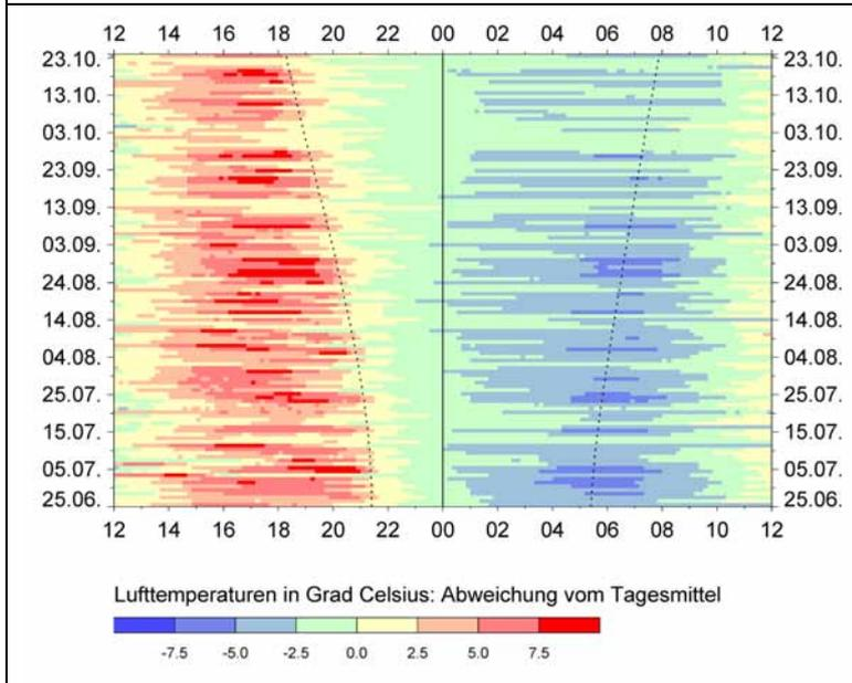
Abbildung 173: Isoplethendarstellung der Lufttemperaturen an der Station „Scherzach“. Abweichung vom Tagesmittel.
