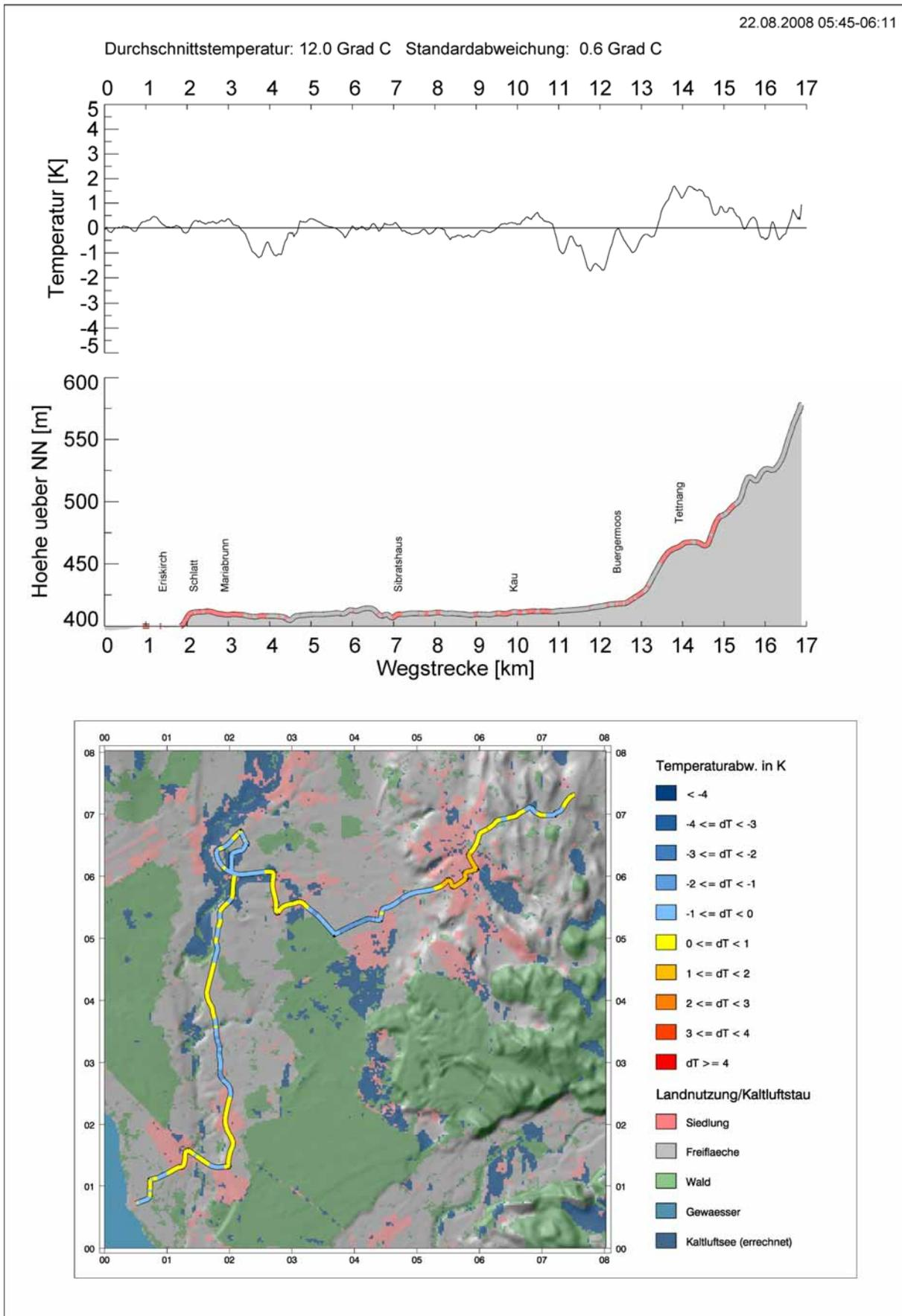
Abbildung 129: Ergebnisse einer Temperaturmessfahrt zwischen Tettnang, Lochbrücke und dem Bodenseeufer bei Erikskirch am 22.08.2008, 05:45 Uhr – 06.11 Uhr MESZ.
