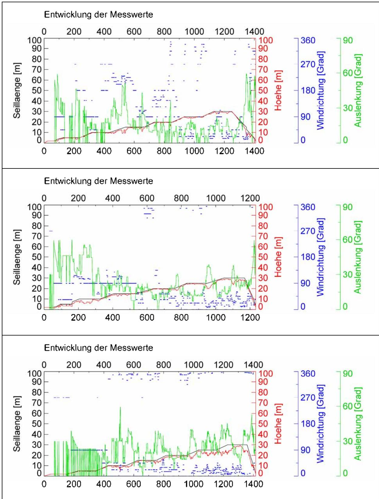
Abbildung 77: Liniendiagramme der Auslenkungsstärke des Heliumballons und der Windrichtung am Standort „Raderach“ am 06.08.2008. Von oben nach unten: 1., 2. und 3. Messung. Erläuterungen im Text.
