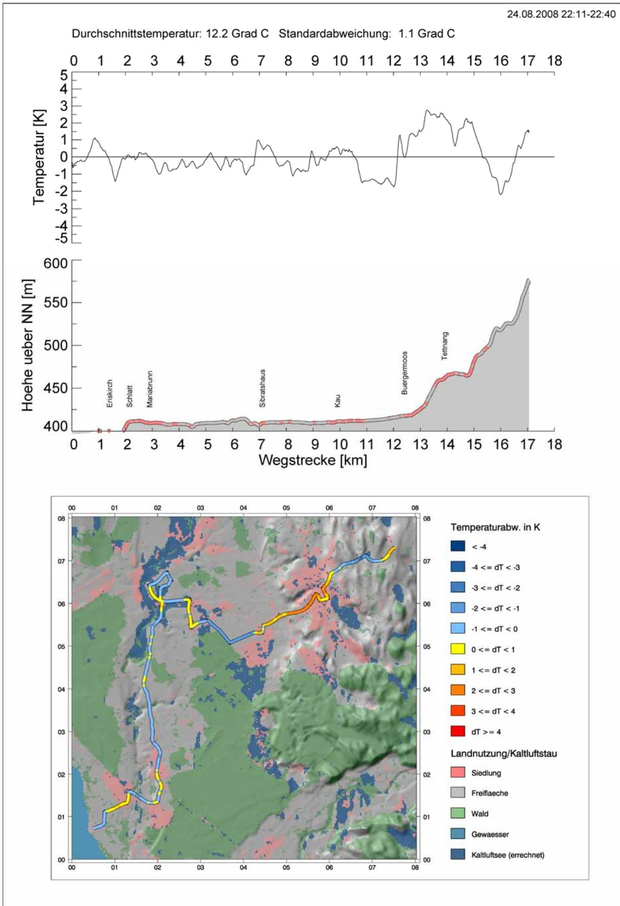
Abbildung 130: Ergebnisse einer Temperaturmessfahrt zwischen Tettnang, Lochbrücke und dem Bodenseeufer bei Eriskirch am 24.08.2008, 22:11 Uhr – 22:40 Uhr MESZ.
